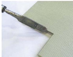
②裁断面の仕上げと畳表のほつれ防止のため、はんだこて、アイロンなどで畳表の端面を溶かします。(温度は230℃程度が適温です)
